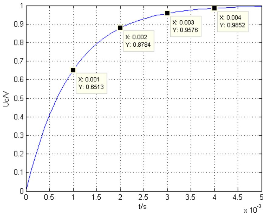
图 8: 实际测试RC充电图形分析
