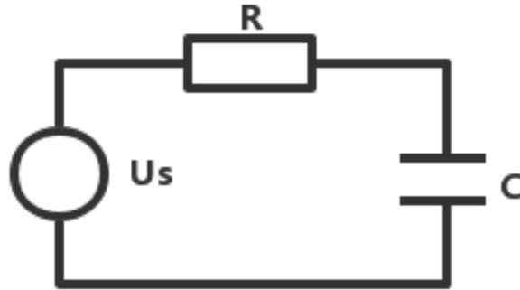
图 5: 电容充电等效电路
