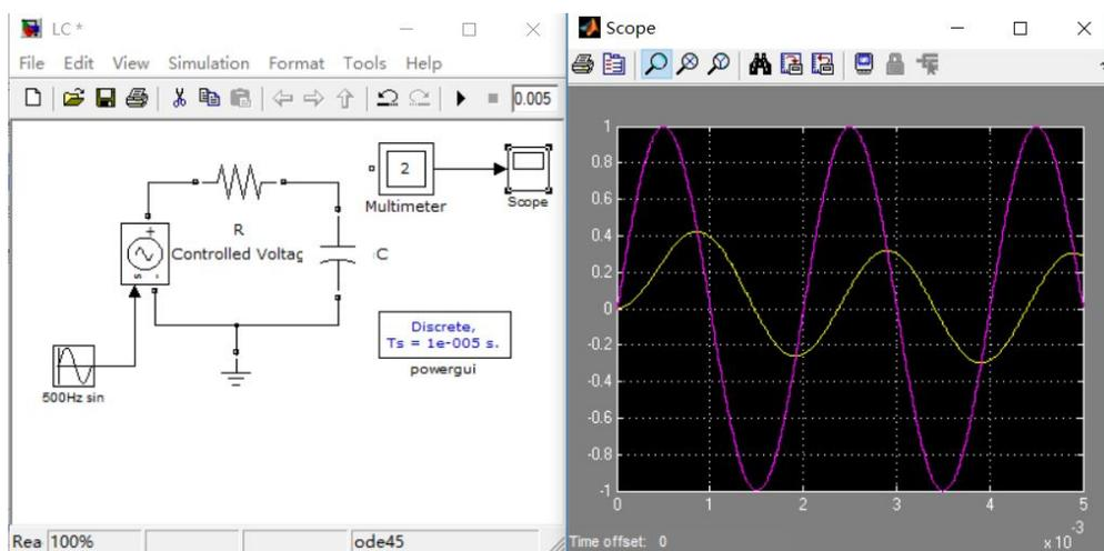
图 10: RC电路对500Hz正弦信号的响应（紫色是 $U_s$ 电压源输入信号，黄色 $U_c$ 电容的电压响应）
