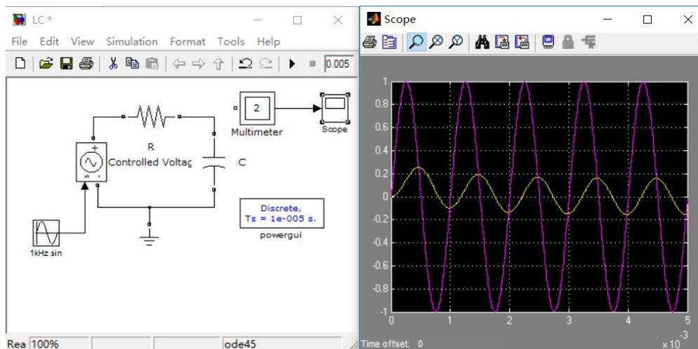
图 9: RC电路对1kHz正弦信号的响应（紫色是 $U_s$ 电压源输入信号，黄色 $U_c$ 电容的电压响应）
