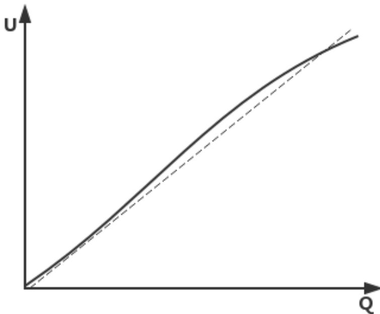
图 4: 电容的电势差与电荷的关系
